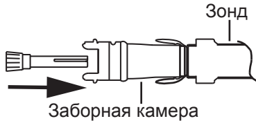
Рис. 2. Установка концевой направляющей в заборную камеру
